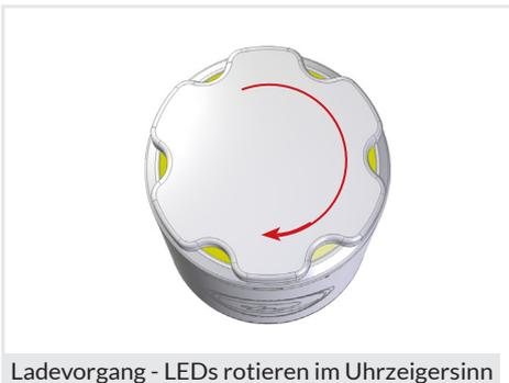
Die Ladegeschwindigkeit bzw. der Ladestrom wird dabei durch eine Rotation der LEDs im Uhrzeigersinn visualisiert. Zum Ende des Ladevorgangs verringert sich der Ladestrom und somit die Rotationsgeschwindigkeit, bis schlussendlich der Ladevorgang abgeschlossen ist und (falls notwendig) die Zellenpflege eingeleitet wird.
