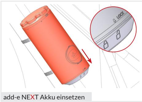
1. Der Akku ist so einzusetzen, dass sich der Pfeil über dem offenen Schloss befindet.
