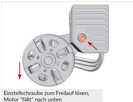
Einstellschraube zum Freilauf lösen, Motor "fällt" nach unten
