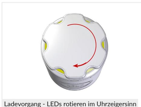
Die Ladegeschwindigkeit bzw. der Ladestrom wird dabei durch eine Rotation der LEDs im Uhrzeigersinn visualisiert. Zum Ende des Ladevorgangs verringert sich der Ladestrom und somit die Rotationsgeschwindigkeit, bis schlussendlich der Ladevorgang abgeschlossen ist und (falls notwendig) die Zellenpflege eingeleitet wird.
