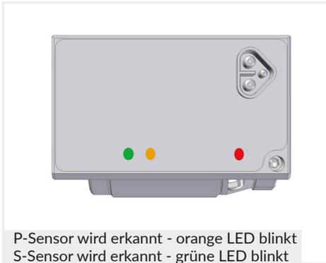
P-Sensor wird erkannt - orange LED blinkt
