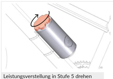
Leistungsverstellung in Stufe 5 drehen
