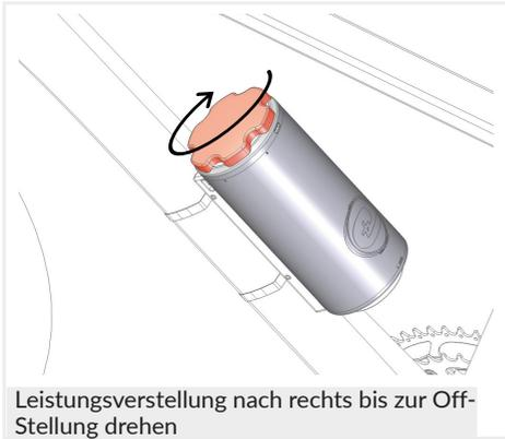
Leistungsverstellung nach rechts bis zur Off-Stellung drehen
