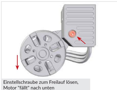
3. Beträgt der Abstand weniger als 2-5 mm, die Einstellschraube zum Freilauf (3) um eine Umdrehung lösen. Es ist nicht notwendig die Schraube komplett herauszuschrauben.
