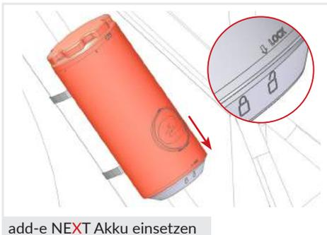
1. Der Akku ist so einzusetzen, dass sich der Pfeil über dem offenen Schloss befindet.
