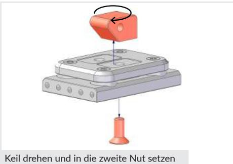
2. Den Keil um 180° drehen und in die zweite Nut versetzen.
