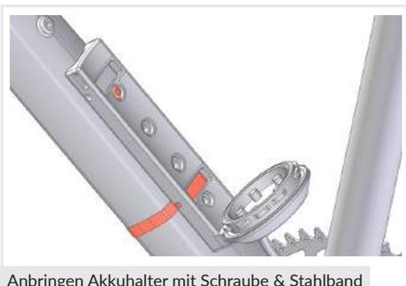
Anbringen Akkuhalter mit Schraube & Stahlband
