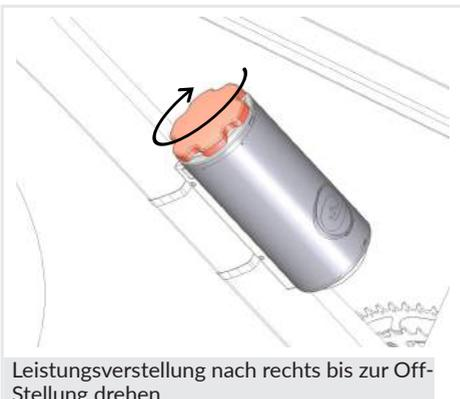
Leistungsverstellung nach rechts bis zur Off-Stellung drehen
