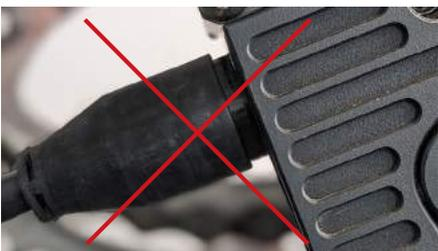
Zwischen Anschlussstecker auf der Antriebseinheit und Akkustecker darf kein Abstand sichtbar sein!
