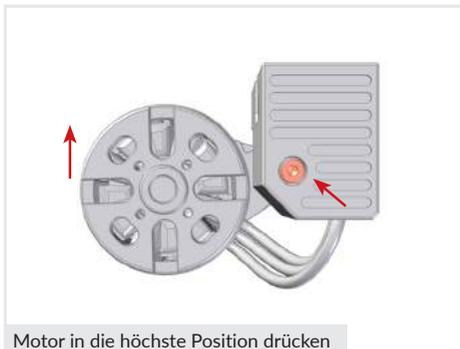
4. Den Motor bis zum Anschlag hochdrücken und die Einstellschraube (3) **in dieser Position** handfest anziehen.
