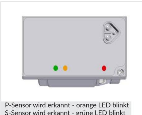
P-Sensor wird erkannt - orange LED blinkt
