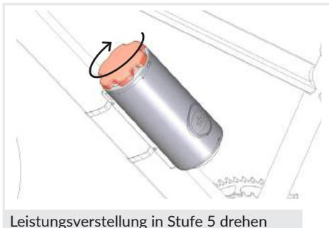
Leistungsverstellung in Stufe 5 drehen
