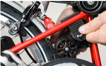
Einstellschraube zum Freilauf lösen
