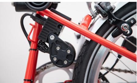
Akkukabel mit Antrieb verbinden
