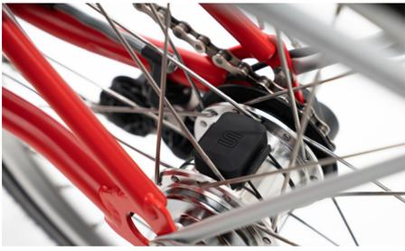
Speed-Sensor Radnabe hinten
