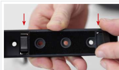
Stahlbändern in den Akkuhalter führen
