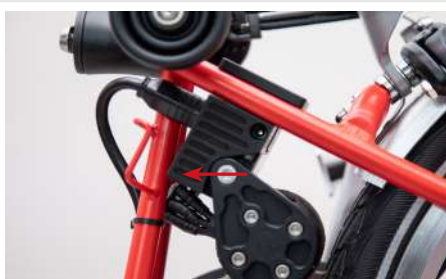
Elektronikblock liegt an den Rahmenstreben an
