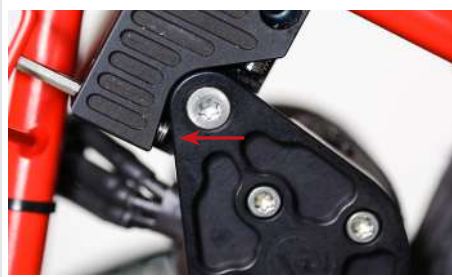
Schraube berührt den Schwingarm nicht
