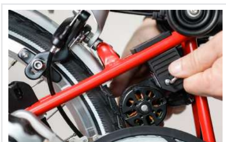
Einstellschraube zum Freilauf lösen
