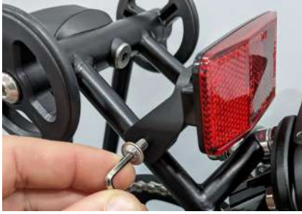
Bei P & T Line Rückstrahler demontieren
