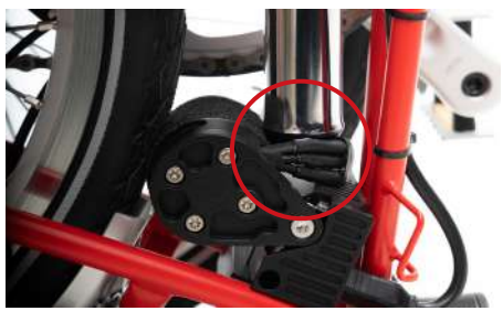
Gummipuffer drückt gegen den Motor, Kabel werden NICHT gequetscht!
