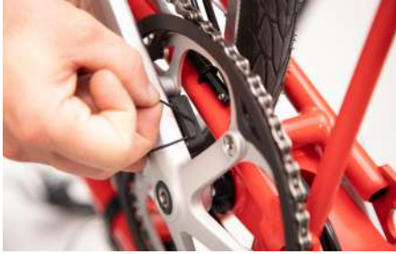
PAS-Sensor Innenseite der Tretkurbel befestigen
