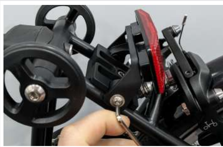
Montageplatte mit dem Rückstrahler befestigen
