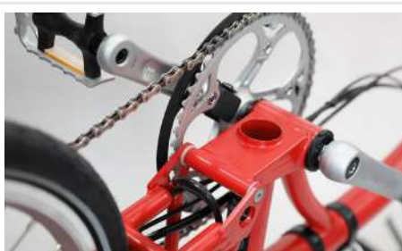
Akkukabel darf nicht eingeklemmt werden
