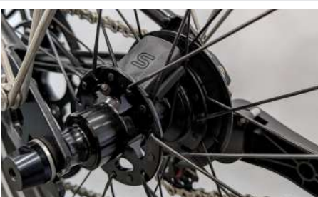
Bei P & T Line kann der Sensor schräg sitzen
