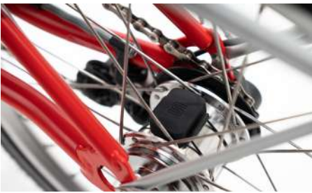
Speed-Sensor Radnabe hinten
