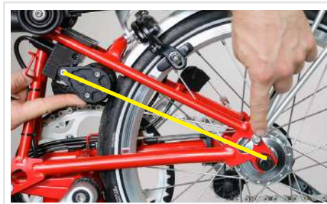
Gedachte Linie zwischen Motor- und Hinterradmitte
