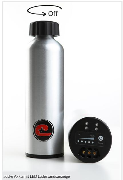
**Die Ladestandsanzeige** befindet sich am Akkuboden als Spannungsanzeige und ist ein Richtwert zur Restkapazität. Ist der Akku vollgeladen, so leuchten alle LEDs: 1x rot, 2x gelb und 2x grün. Ist der Akku leer, leuchtet nur mehr die rote LED.
