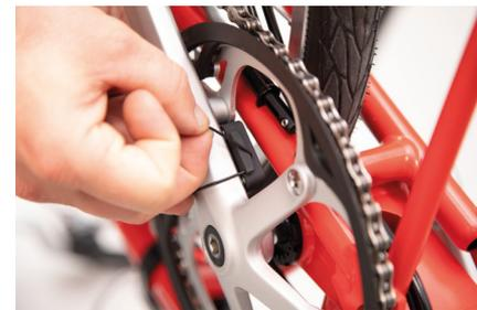
PAS-Sensor an der Innenseite der Tretkurbel befestigen
