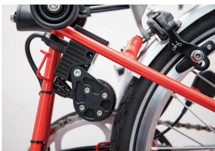
Antriebseinheit und Batterie verbinden
