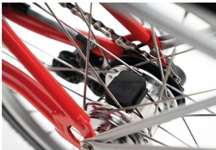
Speed Sensor an der Hinterradnabe befestigen
