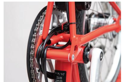
Das Batteriekabel darf nicht eingeklemmt werden
